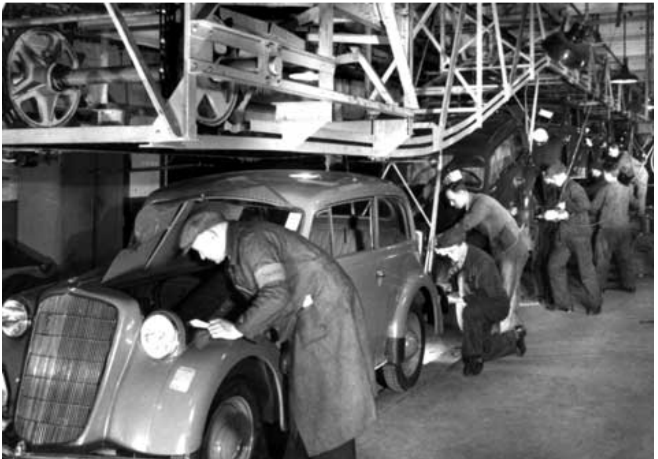
Gewissenhafte Prüfung der Inspekture: Nach Hochzeit und letzten Montagearbeiten gelangen die fertig gestellten Fahrzeuge zur Qualitätskontrolle am Ende des Bandes.
